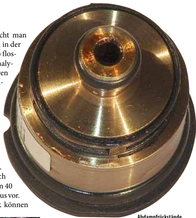
Abdampfdruckstände an LPG-Injektoren können bis zu 30 Prozent weniger Förderleistung bedeuten.
