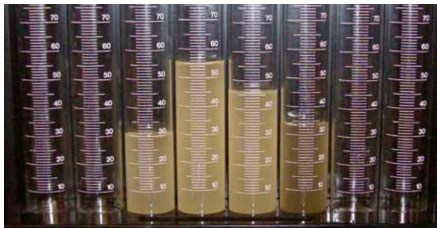
Die Unterschiede in den Einspritzmengen sind deutlich erkennbar. Bereits nach 30.000 Kilometern können sie zu kapitalen Motorschäden führen.
