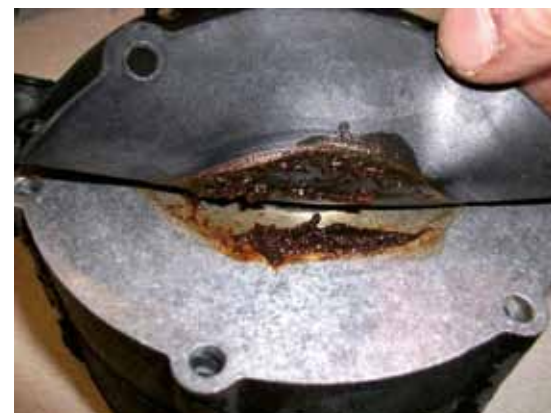
Bereits nach wenigen tausend Kilometern finden sich auch LPG-Abdampf-rückstände im Verdampfer
