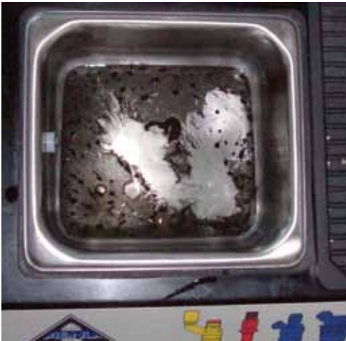
Rückstände von LPG-Injektoren nach Reinigung per Ultraschall
