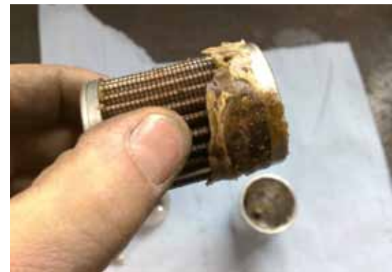
An relativ kühlen Bauteilen, wie dem LPG-Filter, setzen sich LPG-Abdampf-rückstände besonders schnell ab
