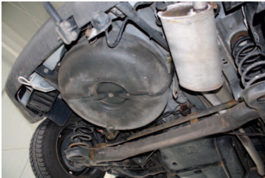
Ein abschreckendes Beispiel, wie man es bei vielen Umbauten in Hinterhofwerkstätten sieht: Der Gastank wurde nur mit einem flexiblen Stahlband am Fahrzeugboden befestigt. Solche Beispiele findet man en masse bei Billigeinbauten.
